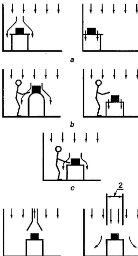
a - за счет лучшего расположения оборудования; b - за счет лучшей формы оборудования и рабочего места;
