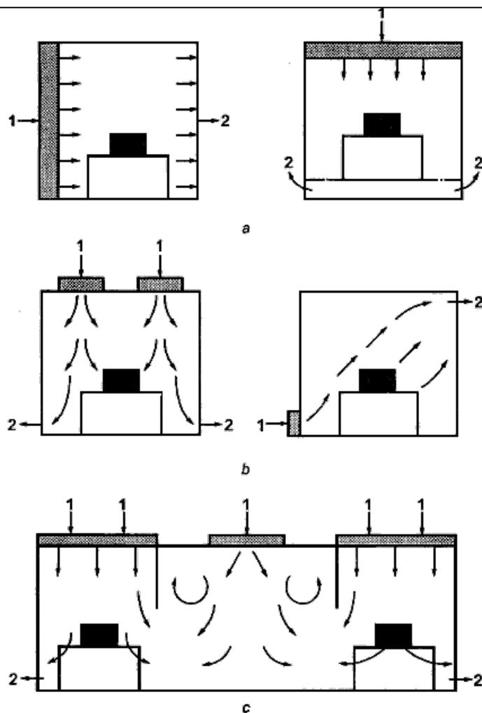
а - однонаправленный поток воздуха; б - неоднаправленный поток воздуха; в - смешанный поток воздуха;
