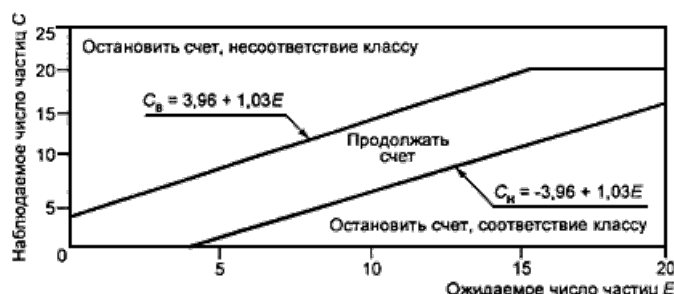
Рисунок F.1 - Границы соответствия и несоответствия классам чистоты при использовании метода последовательного отбора проб
