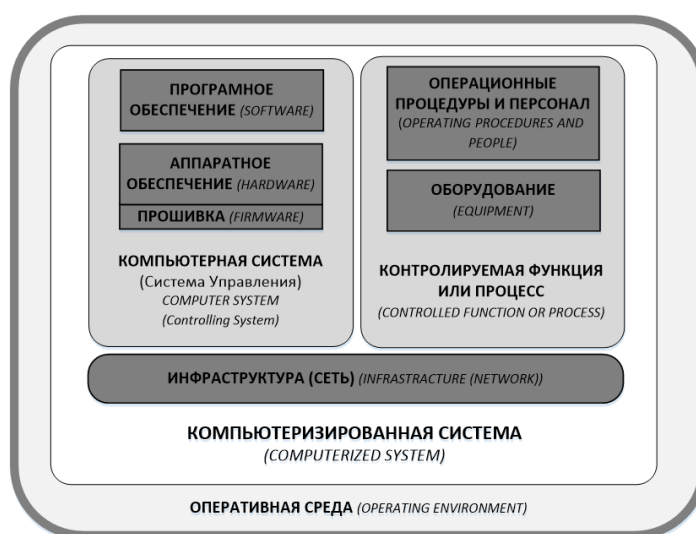
Рис.1 Схема взаимосвязи различных компонентов компьютеризированной системы в ее операционной среде. ПИ 011-3 25 сентябрь 2007
