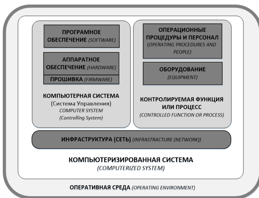
Рис.1 Схема взаимосвязи различных компонентов компьютеризированной системы в ее операционной среде. PI 011-3 25 сентябрь 2007
